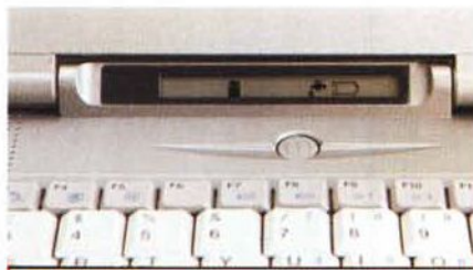
Il pannello LCD posto alla base del monitor consente di tenere d'occhio varie funzioni del computer, come lo stato delle batterie, la presenza o meno dell'alimentazione di rete, lo stato dei vari pulsanti CapsLock, NumLock, ecc., e l'utilizzazione del floppy, hard disk o CD-ROM.
